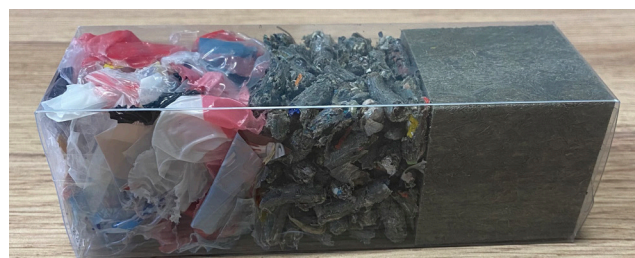
La chaîne du recyclage - le produit plastique dit secondaire devient du granit hanit® et enfin un matériau pour un nouveau produit
